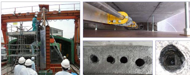
写真-1 フーチング削孔試験状況
